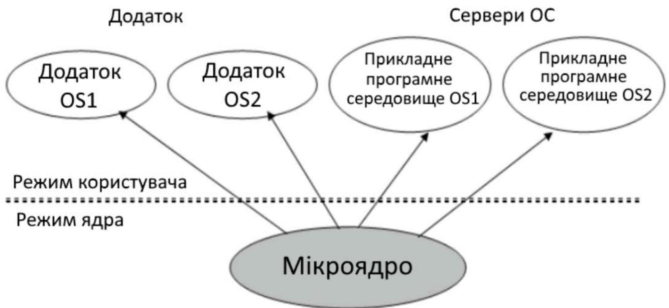
Рисунок 3. 13 – Мікроядерний підхід до реалізації багатьох прикладних середовищ
