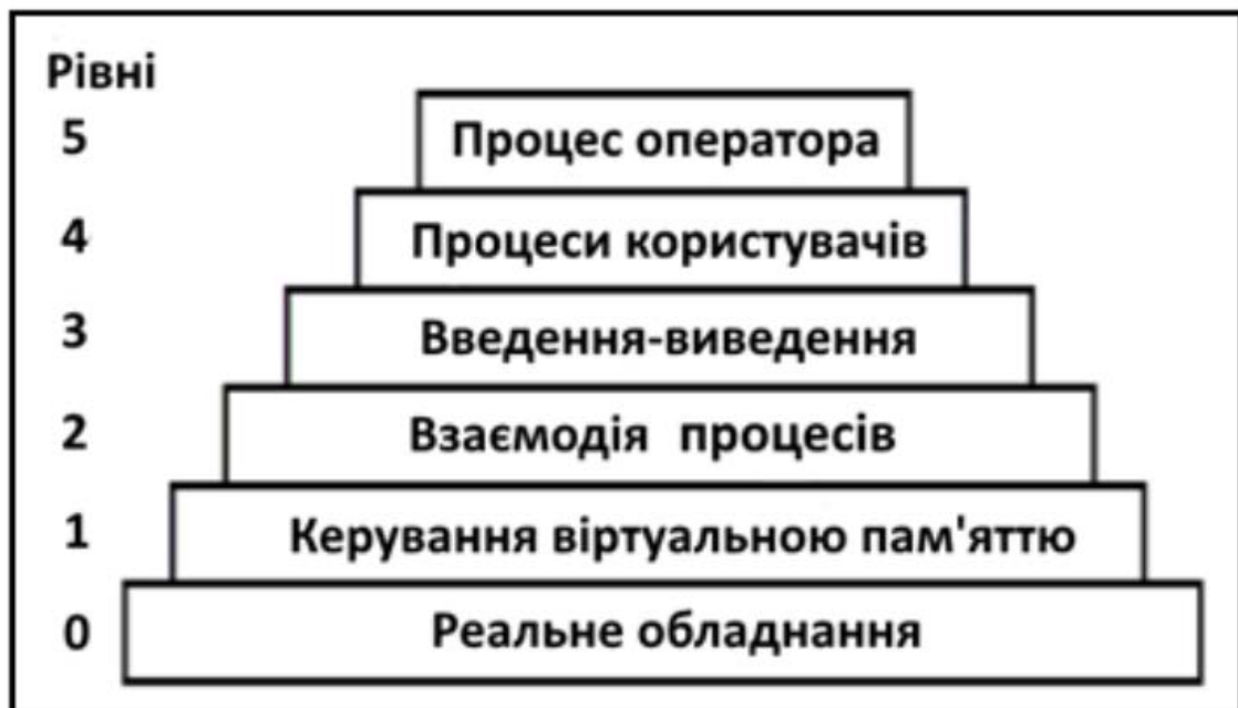
Рисунок 3.6 – Багатошарова операційна система THE
