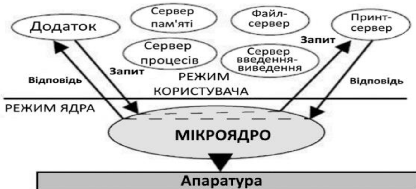
Рисунок 3.11 – Структура ОС клієнт-сервер
