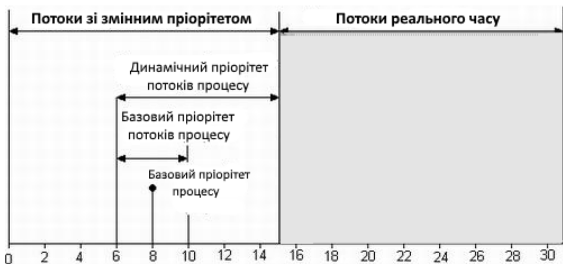
Рисунок 12.6 – Схема призначення пріоритетів у Windows NT
