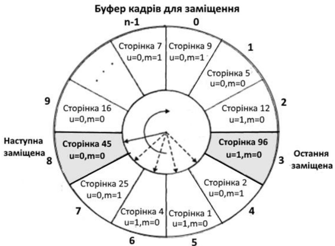
Рисунок 11.6 – Модифікований годинниковий алгоритм заміщення сторінок
