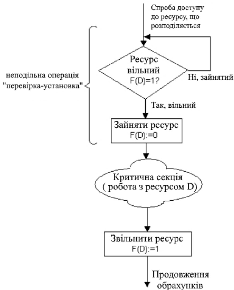
Рисунок 7.4 – Реалізація критичних секцій з використанням блокуючих змінних
