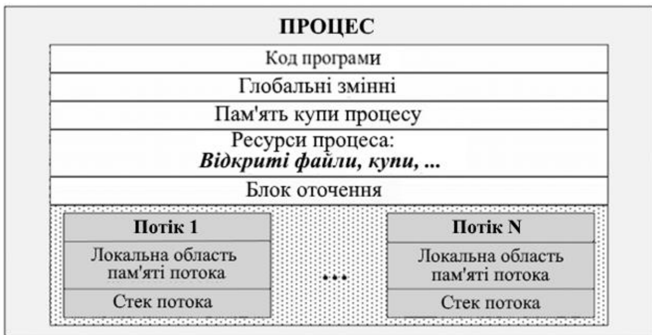
Рисунок 6.7 – Структура процесу і його потоків Атрибути процесу і потоку в Windows наведені в таблиці 6.2.
