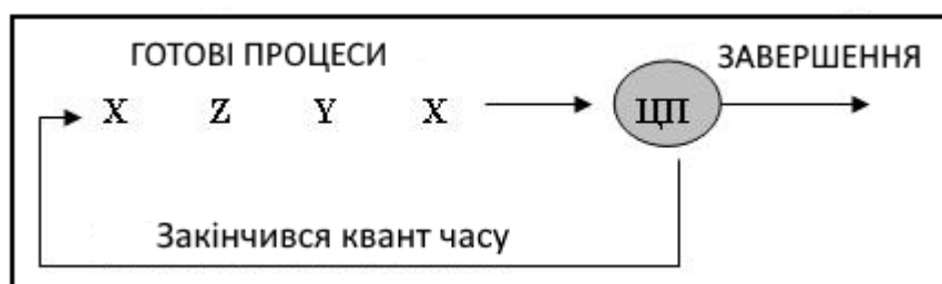
Рисунок 12.12 – Планування за принципом RR
