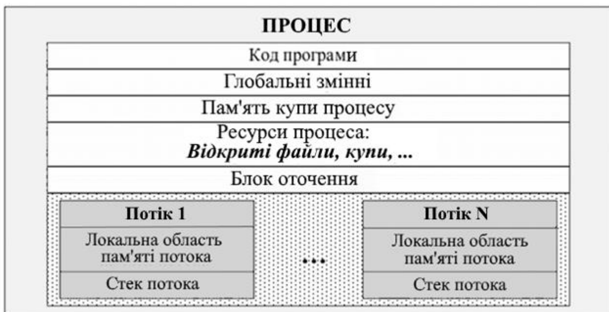
Рисунок 6.7 – Структура процесу і його потоків
