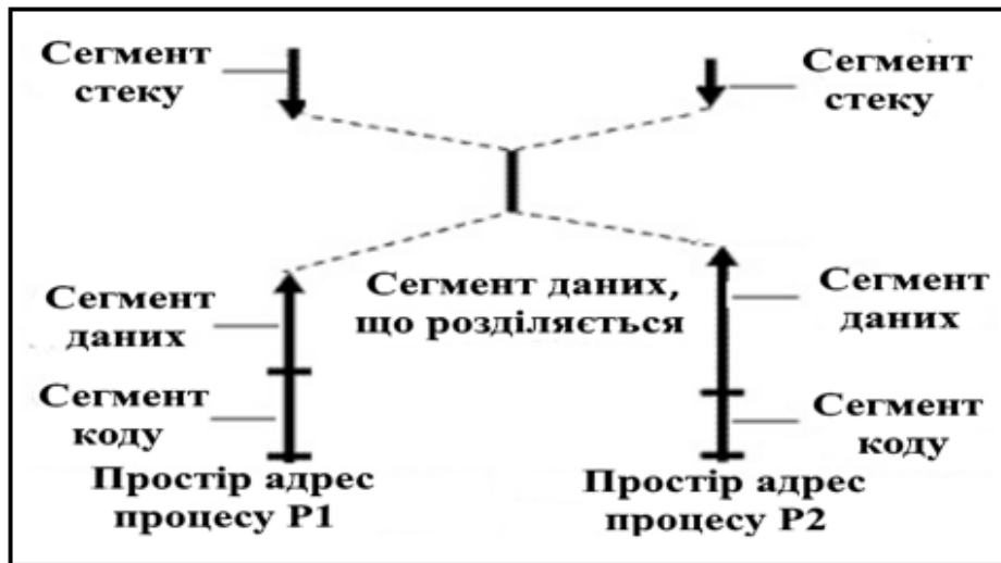
Рисунок 5.9 – Адресні простори процесів, взаємодіючих через сегмент пам'яті
