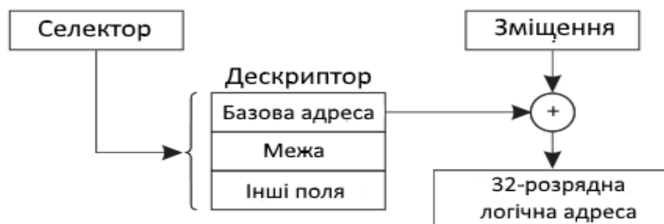
Рисунок 10.29 – Перетворення пари селектор-зміщення в лінійний адрес
