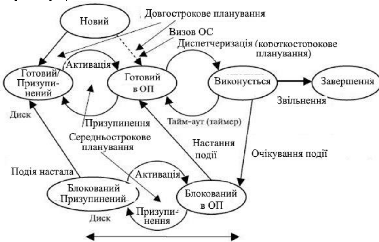
Рисунок 5.6 – Діаграма стану процесу з операціями призупинення і відновлення
