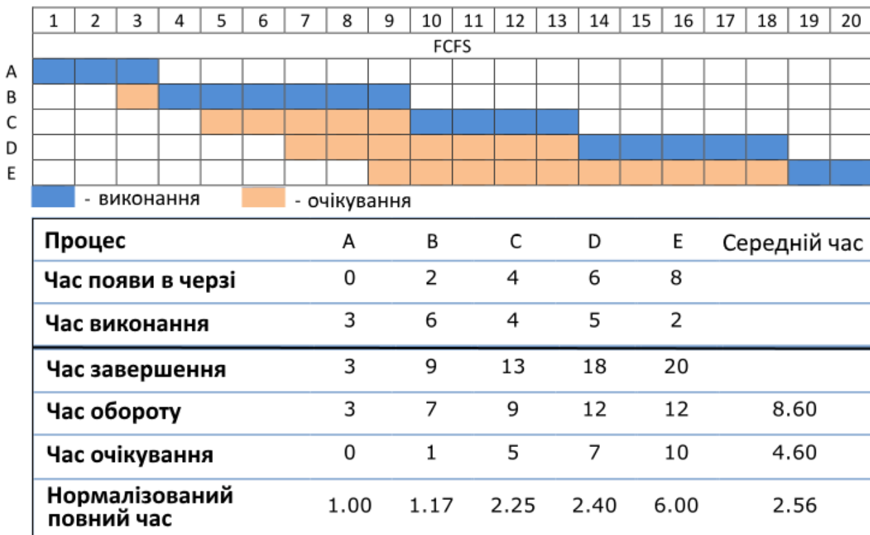
Рисунок 12.11 – Виконання процесів алгоритмом FCFS
