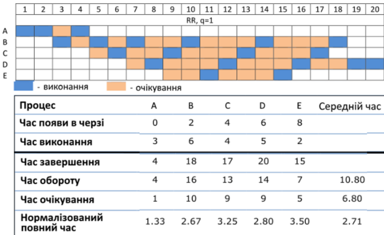
Рисунок 12.14 – Виконання процесів алгоритмом RR з квантом часу q=1
