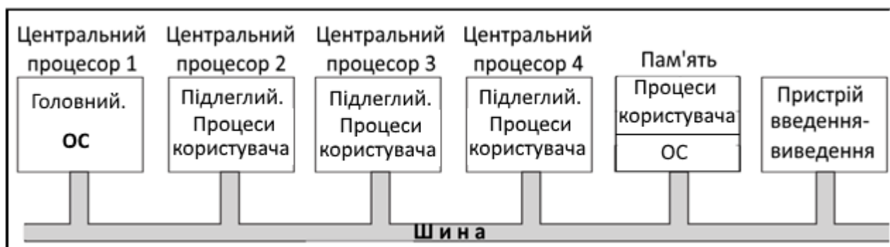
Рисунок 13.7 – Мультипроцесорна модель «головний-підлеглий»
