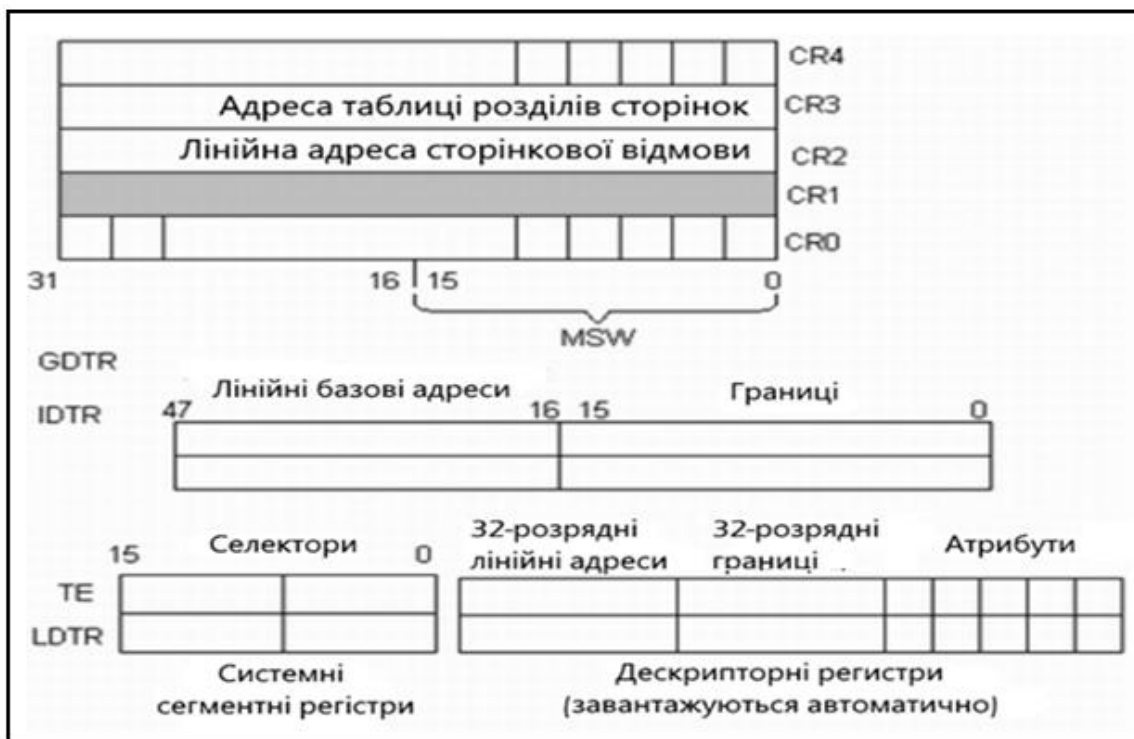
Рисунок 4.2 – Керуючі і системні регістри процесора Pentium
