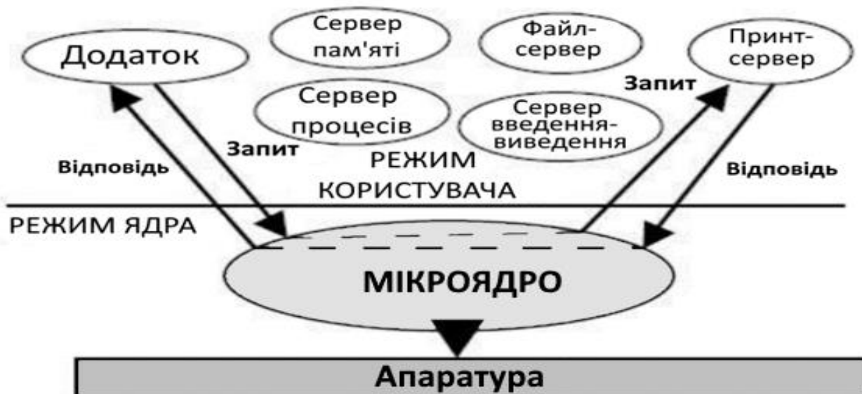
Рисунок 3.11 – Структура ОС клієнт-сервер
