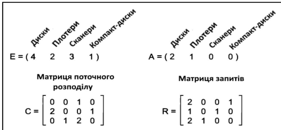
Рисунок 9.6 – Приклад, що демонструє роботу алгоритму виявлення взаємних блокувань
