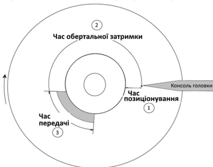
Рисунок 15.7 – Складові часу дискового доступу
