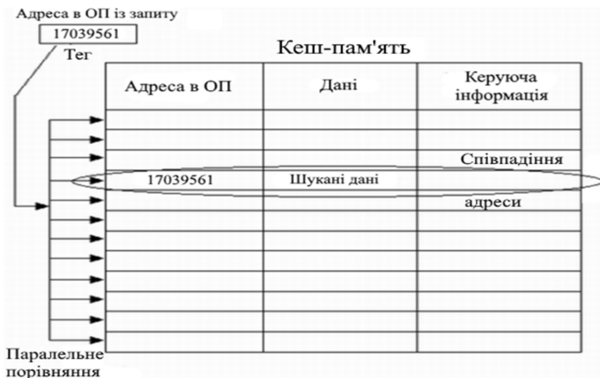
Рисунок 4.6 – Асоціативний пошук в кеші з випадковим відображенням
