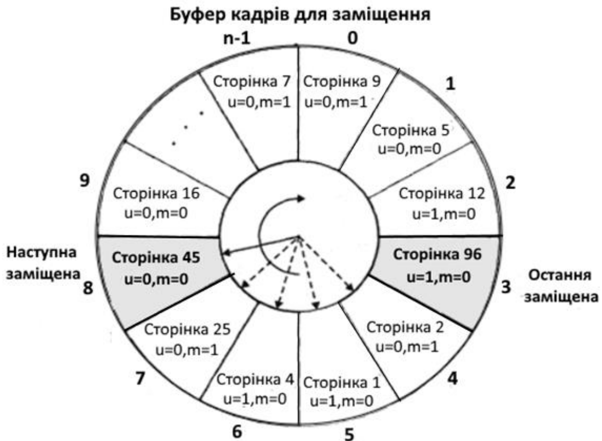
Рисунок 11.6 – Модифікований годинниковий алгоритм заміщення сторінок
