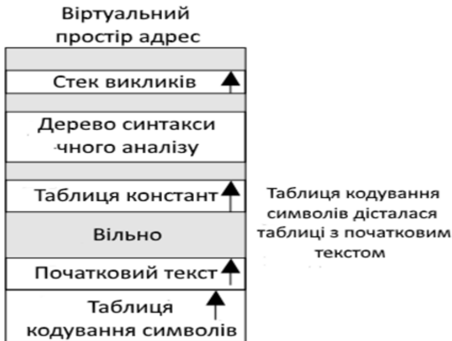
Рисунок 10.19 – Розміщення таблиць компілятора в одновимірному адресному просторі
