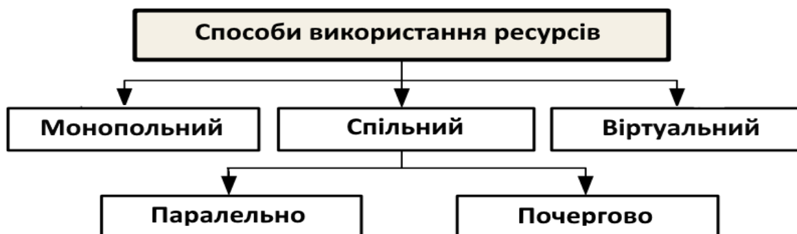
Рисунок 5.3 – Способи використання апаратних ресурсів
