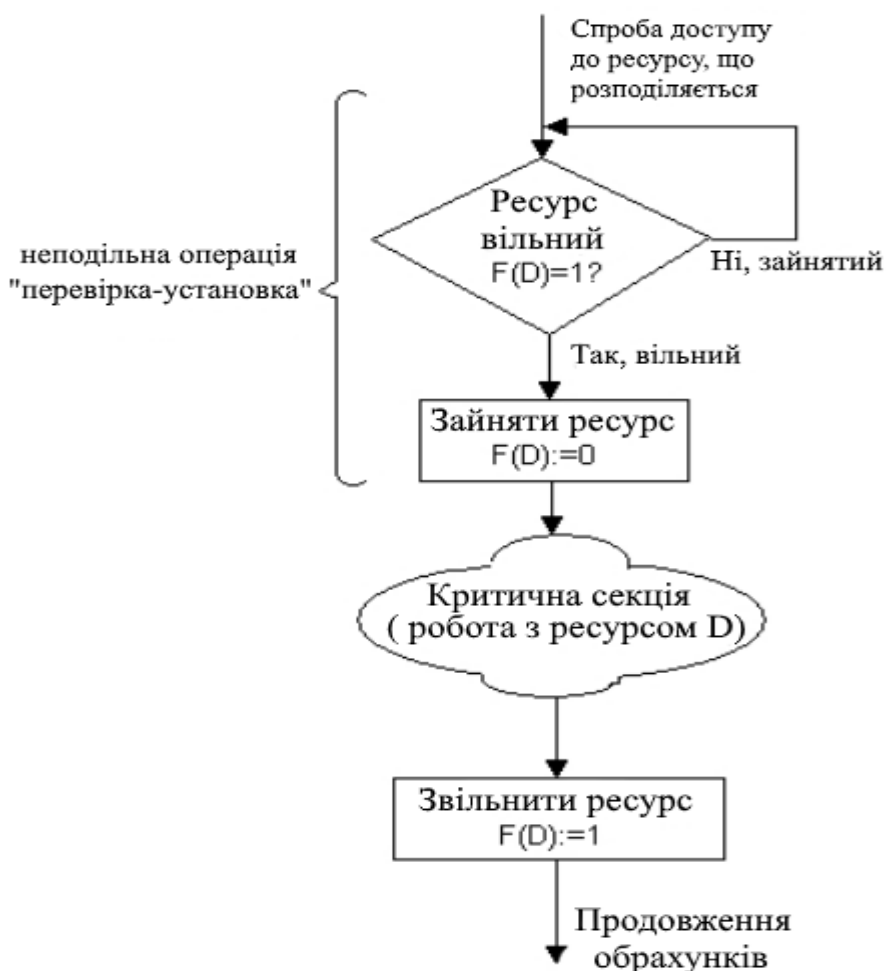
Рисунок 7.4 – Реалізація критичних секцій з використанням блокуючих змінних
