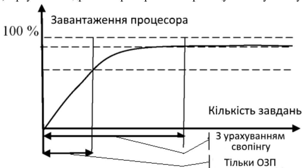
Рисунок 10.35 – Завантаження процесора при використанні свопінгу
