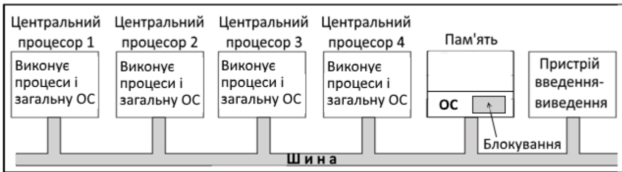
Рисунок 13.8 – Модель симетричного мультипроцесора
