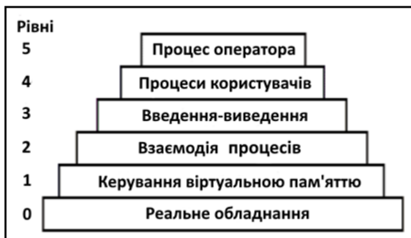
Рисунок 3.6 – Багатошарова операційна система THE
