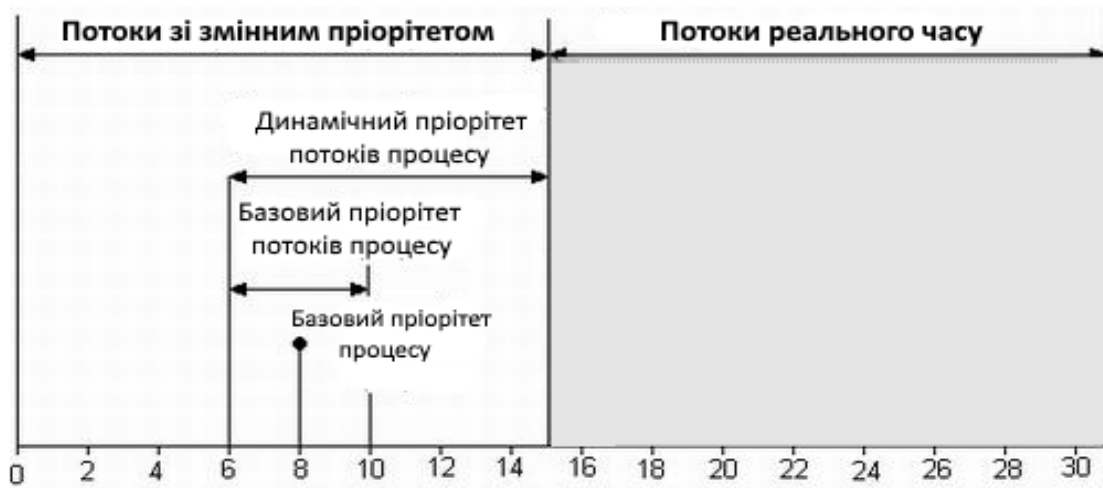
Рисунок 12.6 – Схема призначення пріоритетів у Windows NT
