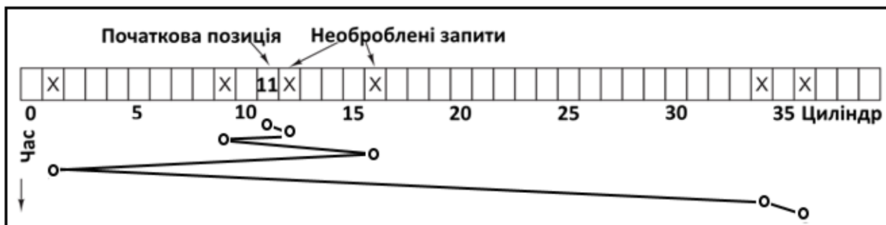
Рисунок 15.9 – Алгоритм планування SSTF
