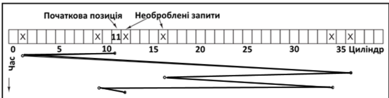
Рисунок 15.8 – Алгоритм планування FCFS
