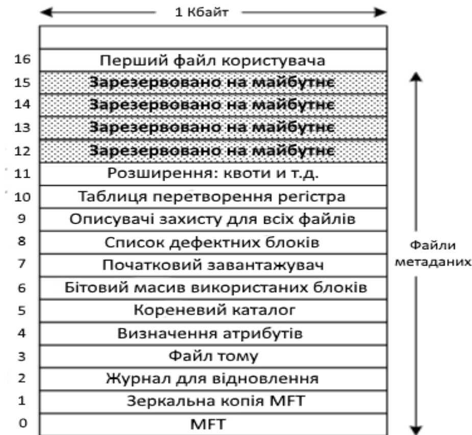
Рисунок 16.11 – Головна файлова таблиця MFT, кожен запис посилається на файл або каталог
