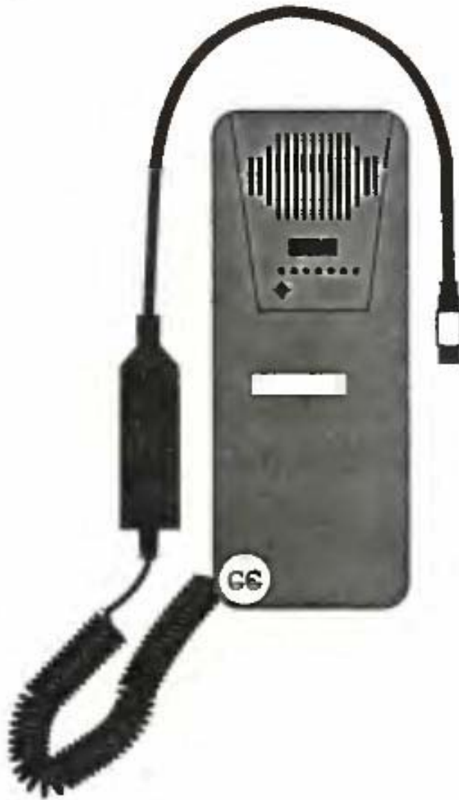
Рис. 1.42. Електронний течієшукач TIF - 5750A фірми REFCO Установка для обслуговування кондиціонерів Виробник LAUNCH
