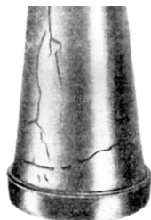
Рис. 2. Осад магнітного порошку на гартівних тріщинах у сталевій деталі, які не можна побачити оком
