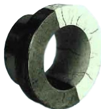
Рис. 3. Осад магнітної суспензії на виявлених дефектах
