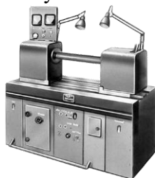
Рис. 4. Універсальний магнітний дефектоскоп з електронним керуванням. Контрольована деталь (вал), установлена в бабках дефектоскопа
