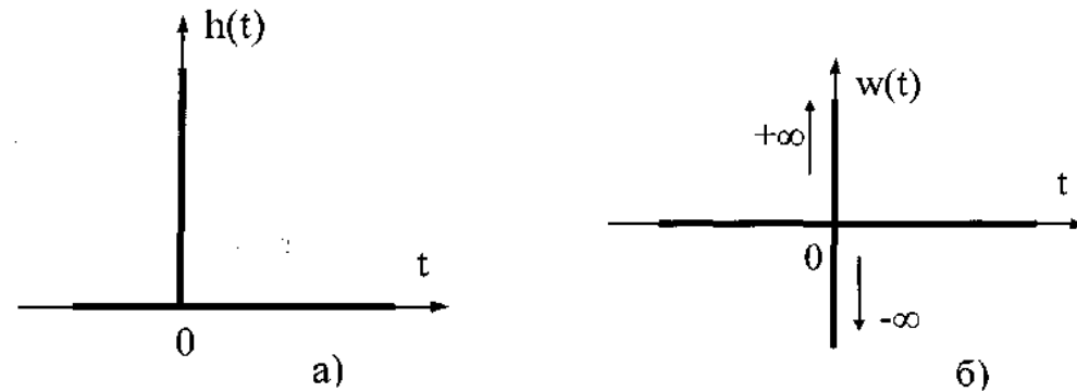
Рис. 4. Перехідна (а) та імпульсна перехідна (б) характеристики диференціальної ланки
