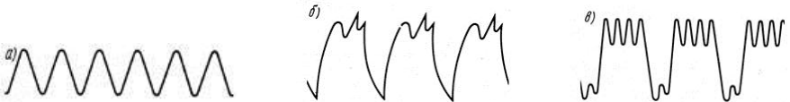
Рисунок 1.10. Форма кривої випрямленої напруги генератора: а — генератор справний; б — вентиль пробитий; в — обрив в колі вентиля (обмотці статора).
