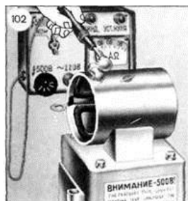
Перевірка обмотки збудження на замикання з корпусом
