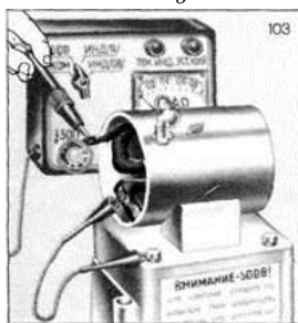
Перевірка обмотки збудження на обрив
