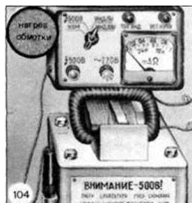
Перевірка котушки обмотки збудження на міжвиткове замикання
