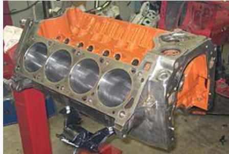
Чавунний блок циліндрів двигуна внутрішнього згорання конфігурації V8
