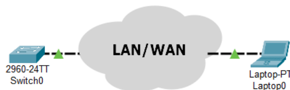
Рисунок 4.3 – Мережеве підключення до керованого комутатора
