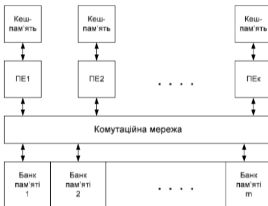
Рисунок 4.3 – Структура паралельної ОС із розподіленою пам'яттю банків з локально-адресованими просторами
