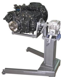
Рисунок 3.28 – Стенди для розбирання агрегатів: а – стенд для розбирання двигунів; б – стенд для розбирання коробок передач
