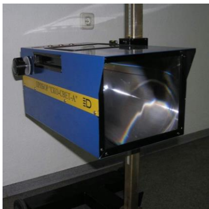
Рисунок 4.5 – Прилад для перевірки напрямку світла фар
