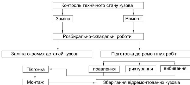
Рисунок 3.30 – Схема технологічного процесу у кузовній дільниці
