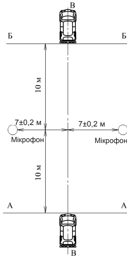
Рис. 4.15. Схема ділянки для вимірювання зовнішнього шуму
