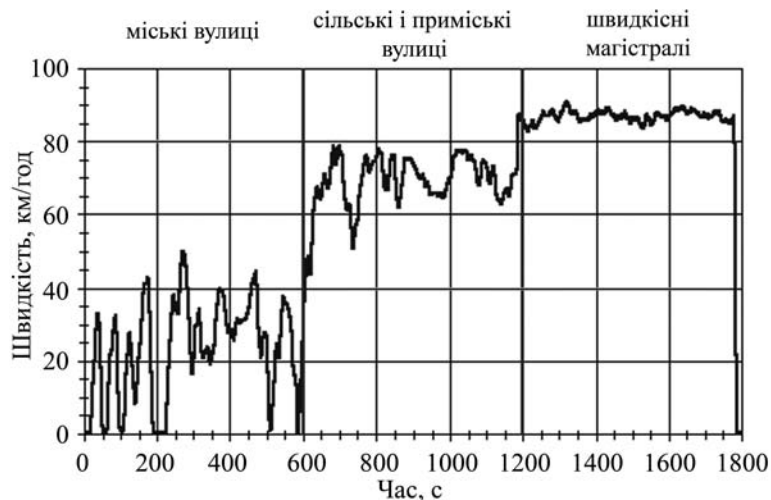
Рис. 5.26. Європейський випробувальний цикл з перехідними режимами
