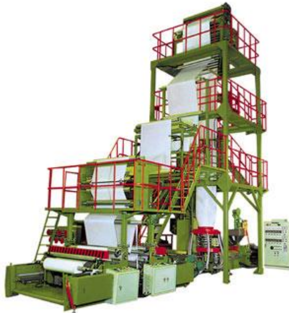
Рисунок 3.4 – Екструдер для виробництва поліетиленової плівки
