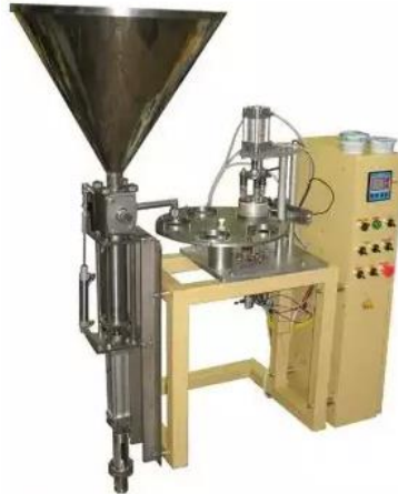
Рисунок 7.2 – Напівавтоматична установка для фасування рідких продуктів 072.32.02
