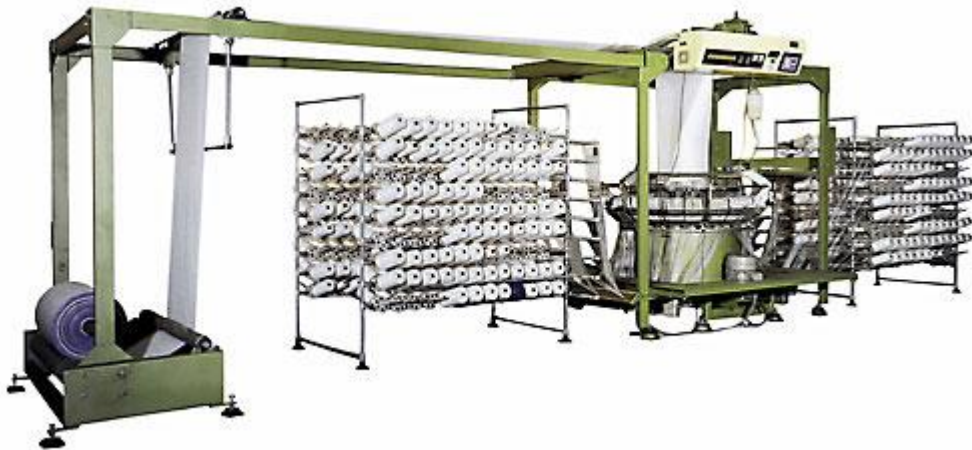
Рисунок 3.6 – Круглоткацький станок для плетення рукава з плоскої нити
