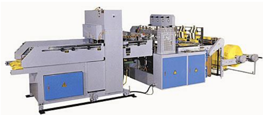
Рисунок 3.5 – Обладнання для виготовлення пакетів «майка»
