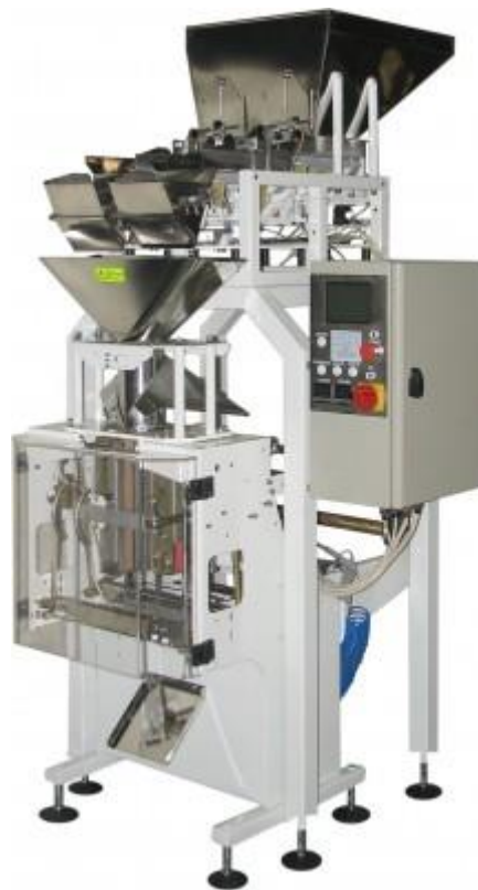
Рисунок 7.3 – Автомат фасувально-пакувальний МАКІЗ ТК 055.00.000.2.1
