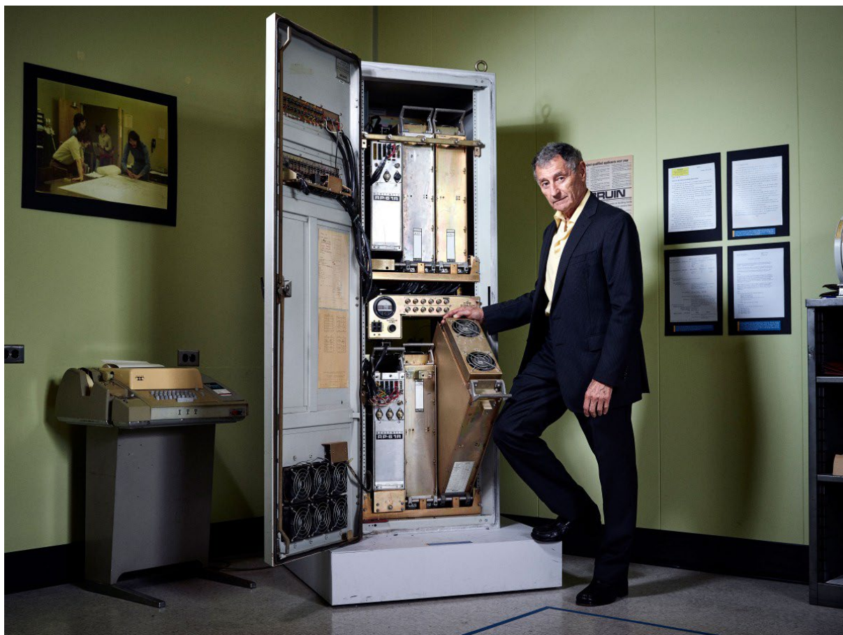
Рисунок 1.1 – Леонард Клейнрок та один з перших комутаторів пакетів – прототип сучасних маршрутизаторів
