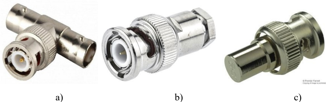
Рисунок 1.12 – З'єднувачі для коаксіального кабелю: а) T-конектор BNC; б) I-конектор BNC; в) термінатор
