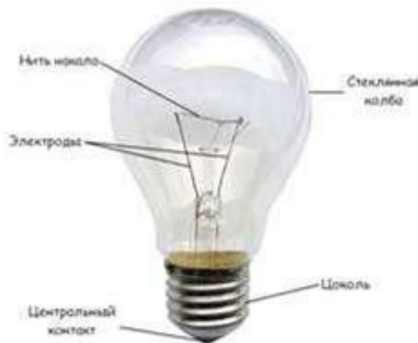
Рисунок 9.1 – Структура ламп розжарювання
