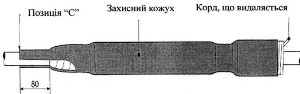
Рисунок 7.15 – Монтаж кабельної муфти, етап дев'ятий
