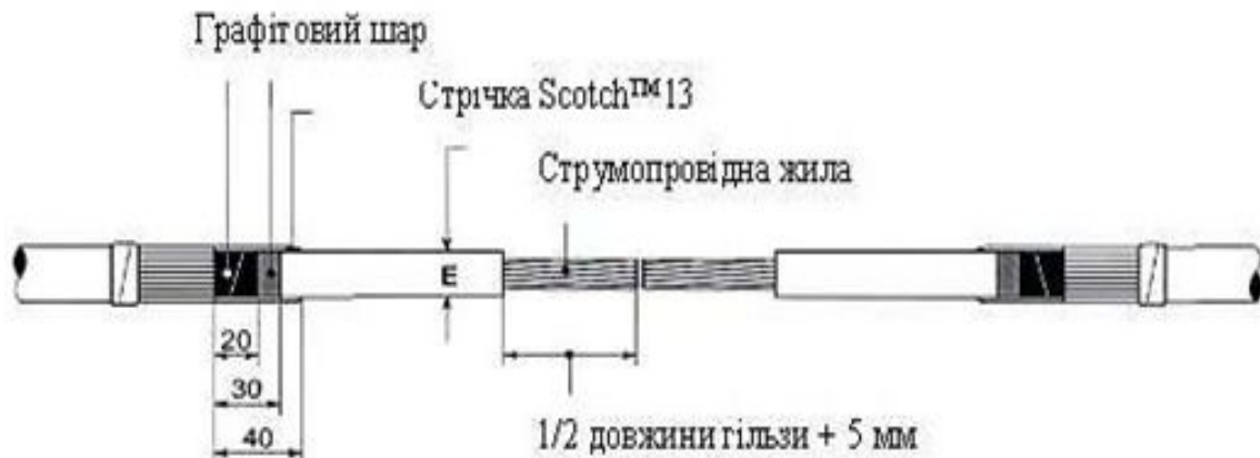
Рисунок 7.9 – Монтаж кабельної муфти, етап третій
