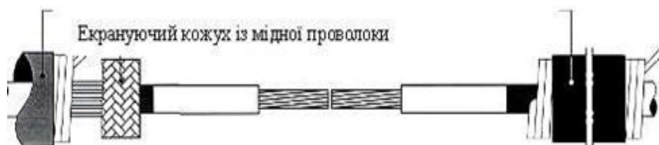
Рисунок 7.10 – Монтаж кабельної муфти, етап четвертий
