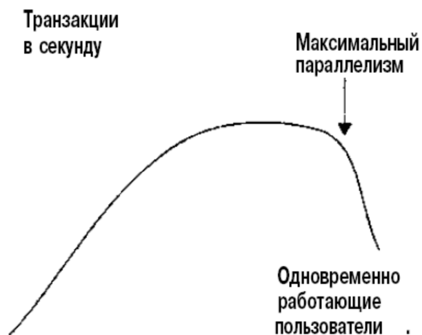
Рис. Иллюстрация зависимости выполняемых транзакций в секунду от количества одновременно работающих пользователей
