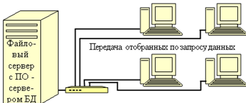
Рис. Схема работы с БД в рамках архитектуры клиент-сервер
