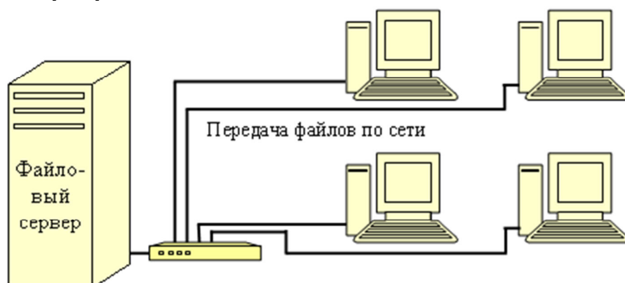
Рис. Схема работы с БД в локальной сети с выделенным файловым сервером
