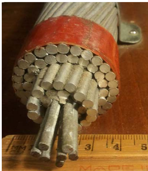
Рисунок 2.16 – Зовнішній вигляд багатодровових проводів повітряних ліній електропередавання
