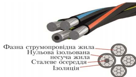
б) СП з ізолюваною несучою нулевою жилою (СП-2)
