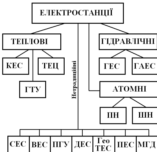
Рисунок 1 – Класифікація електростанцій: КЕС – конденсаційні; ТЕЦ – теплоелектроцентралі; ГТУ – газотурбінні; ГЕС – гідроелектростанції; ГАЕС – гідроакumuлюючі; ПН – атомні на повільних нейтронах; ШН – атомні на швидких нейтронах; СЕС – сонячні; ВЕС – вітрові; ПГУ – парогазові; ДЕС – дизельні; Гео ТЕС – геотермальні; ПЕС – припливні; МГД – магнітогідродинамічні
