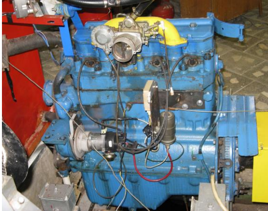
Рис. 4.5. Переобладнаний з дизеля Д-240 газовий двигун на випробувальному стенді
