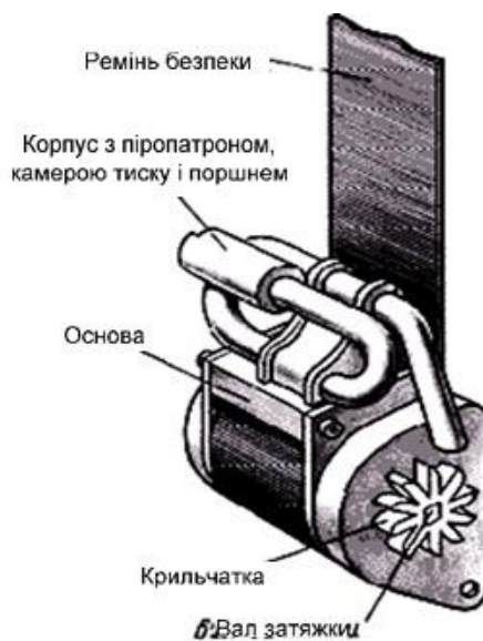
Рисунок 1.4 – Блок керування з пороговими пристроями і піропатронами
