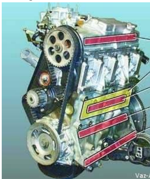
Рис. 7.3. Зони прослуховування стукотів в двигуні: 1. Стукіт корінних підшипників 2. Стукіт шатунних підшипників 3. Стукіт поршневих пальців 4. Стукіт зношених поршнів і циліндрів 5. Детонаційні стукоти 6. Стукіт клапанів
