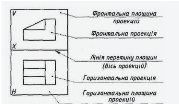
Мал. 4.7. Зображення предмета на двох площинах проєкцій
