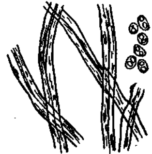
Рис. 1.7. Коконова нитка під мікроскопом
