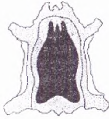
Рис. 2.16 – Міцність шкіри на розрив (темному кольору відповідають найбільш сильно виражені характеристики міцності)
