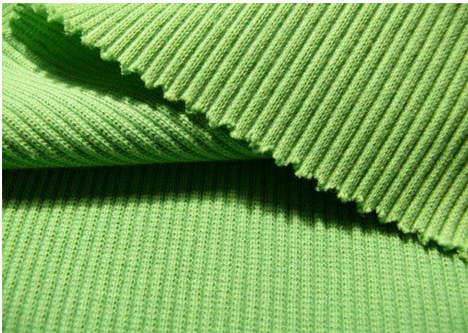
Рис. 1 Трикотажне полотно, вироблене переплетенням «ластик»
