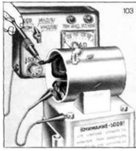
103 Перевірка обмотки збудження на обрив
