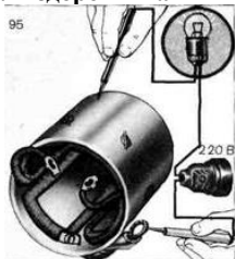
Перевірка обмотки збудження на замикання з корпусом
