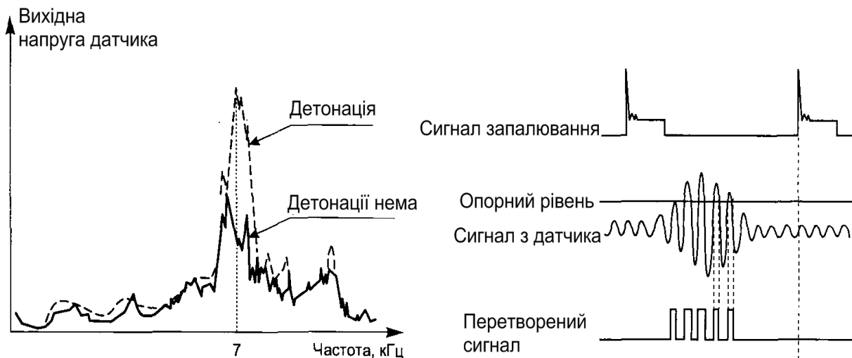
Рисунок 2.37 Вихідний сигнал датчика детонації
