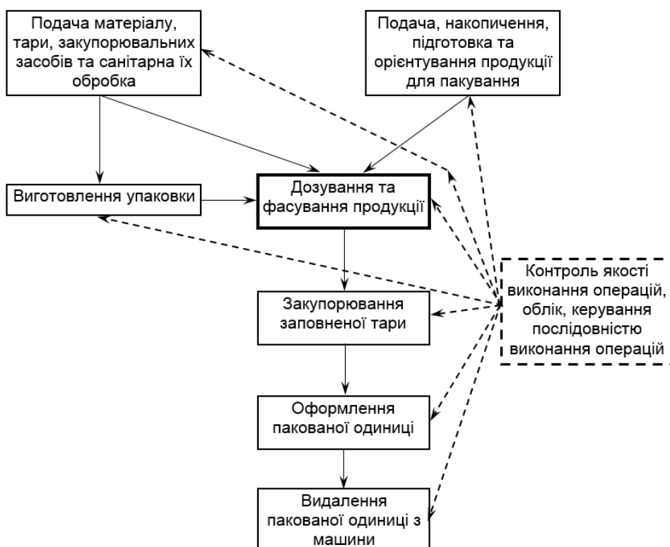
Рис. 2.1 – Технологічний процес пакування готової продукції
