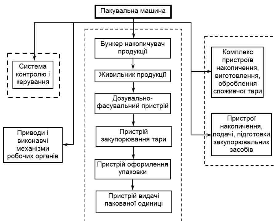
Рис. 2.2 – Структура пакувальної машини для пакування продукції
