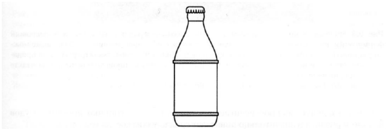
Рис. 11.2 Протиударні ободи скорочують вихід тари з ладу, т.я. навантаження на плечі та основу припадає на виступаючі області. Фактура на цих ободах допомагає знизити шкоду від ударів, що знаходяться в цій зоні [23]
