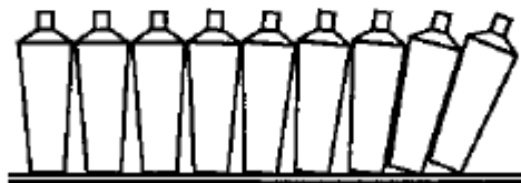
Рис.11.4 Білш широка у верхній частині пляшка може призвести до падіння пляшок на конвеєрі [23]
