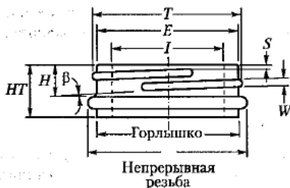
Рис.11.7 – Опис вінчика B – діаметр буртика, \beta - кут підйому різьби, E – діаметр стінок, H – перетин діаметра різьби з обідком або плечиком, HT – висота вінчика, I – внутрішній діаметр вінчика, S – початок різьби, T – діаметр різьби, W – ширина різьби.
