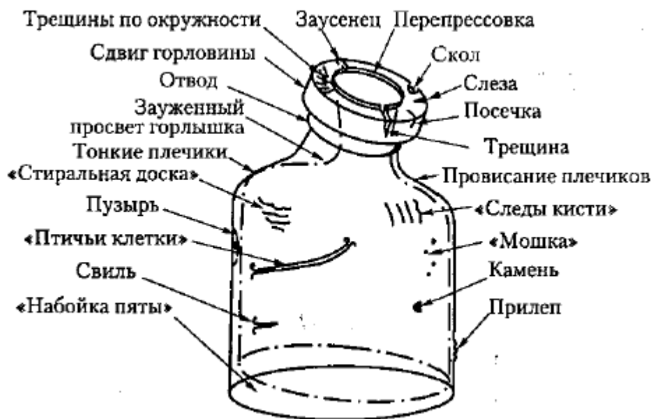
Рис. 11.8 – Типові дефекти скляної тари
