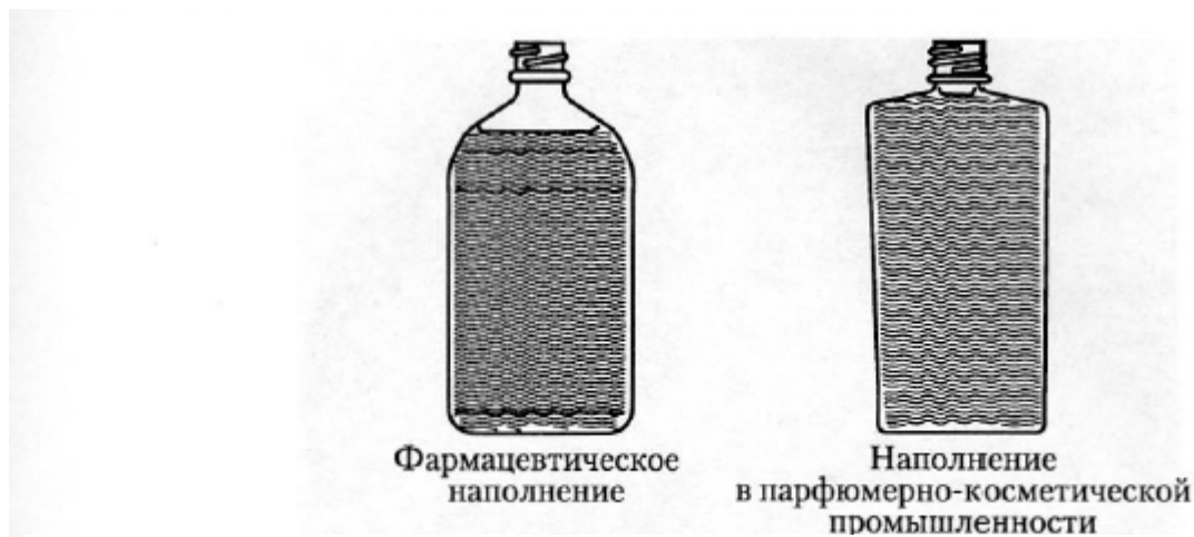
Рис.11.1 Схема заповнення: фармацевтичні пляшки заповнюються до середини плеча, ємності з косметичною або гігієнічною продукцією – до основання з метою покращення зовнішнього вигляду [23].
