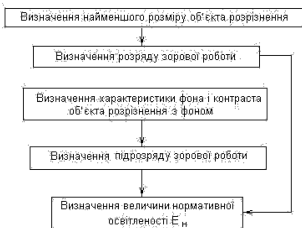
Рис. 2.10 - Алгоритм визначення величини нормованої освітленості ( E_n ) при штучному освітленні
