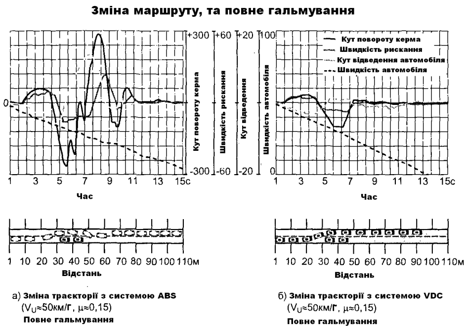
Рисунок 8.9 - Гальмування при русі автомобіля по гладкому льоду
