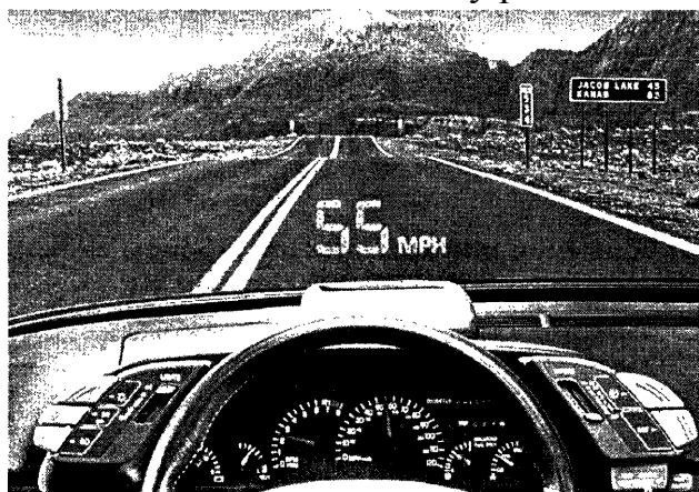
Рисунок 5.13 - Вигляд через вітрове скло автомобілі з HUD
