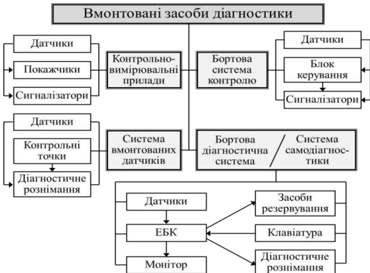
Рис. 2.3.17. Класифікаційна структура вмонтованих засобів діагностики автомобіля
