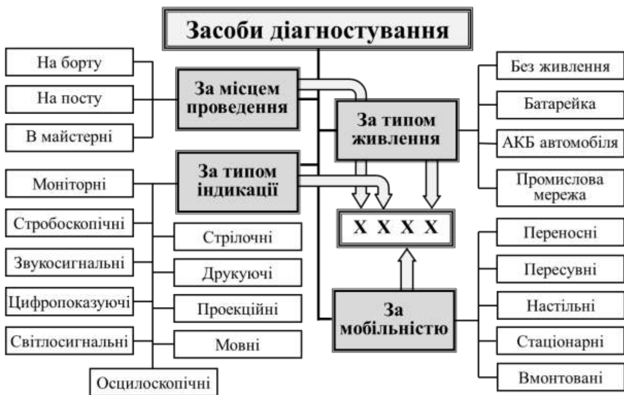
Рис. 2.1.5. Класифікація засобів діагностики за конструкційними ознаками
