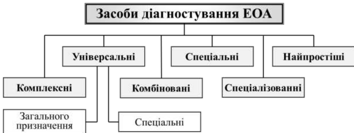
Рис. 2.1.6. Класифікація засобів діагностики електричних пристроїв та систем за функціональним наповненням
