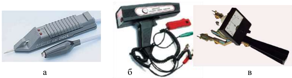
Рис. 2.3.2. Зовнішній вигляд переносних діагностичних приладів: а – логічний пробник (індикатор); б – стробоскоп; в – навантажувальна вилка
