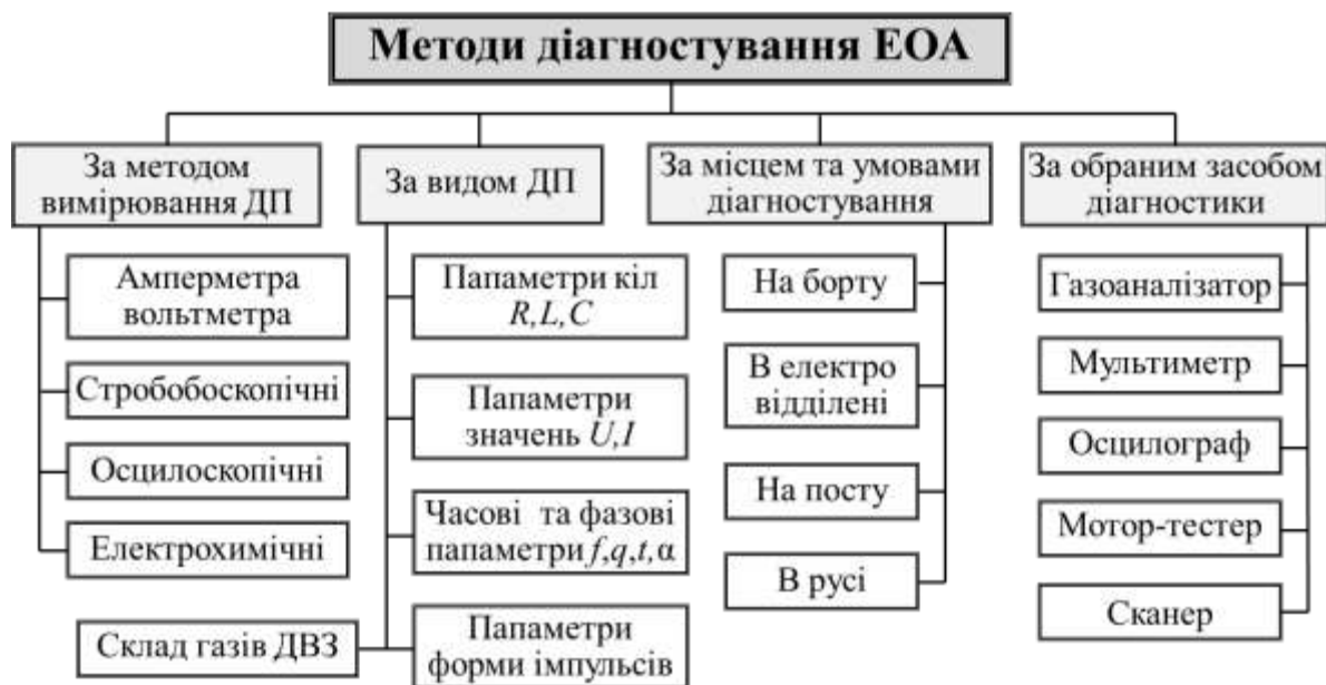
Рис. 2.1.8. Класифікація методів діагностики електричних систем автомобіля
