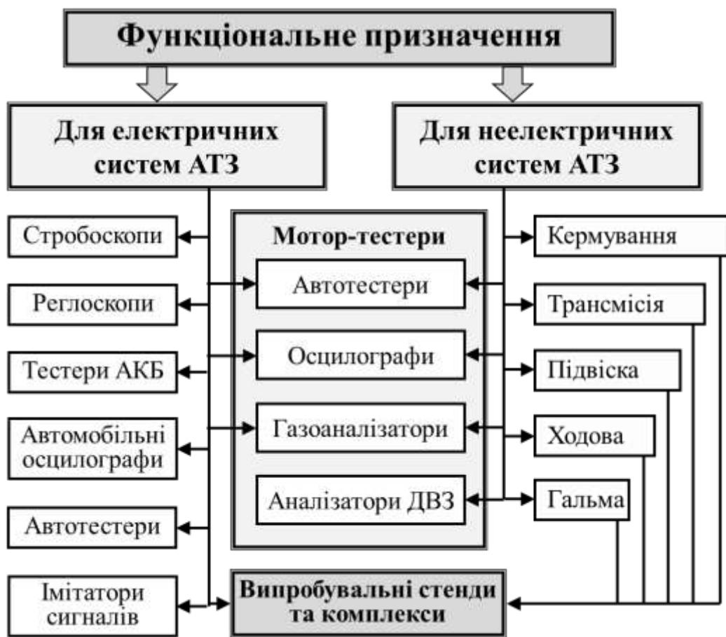
Рис. 2.1.3. Класифікація електричних засобів діагностування АТЗ за призначенням
