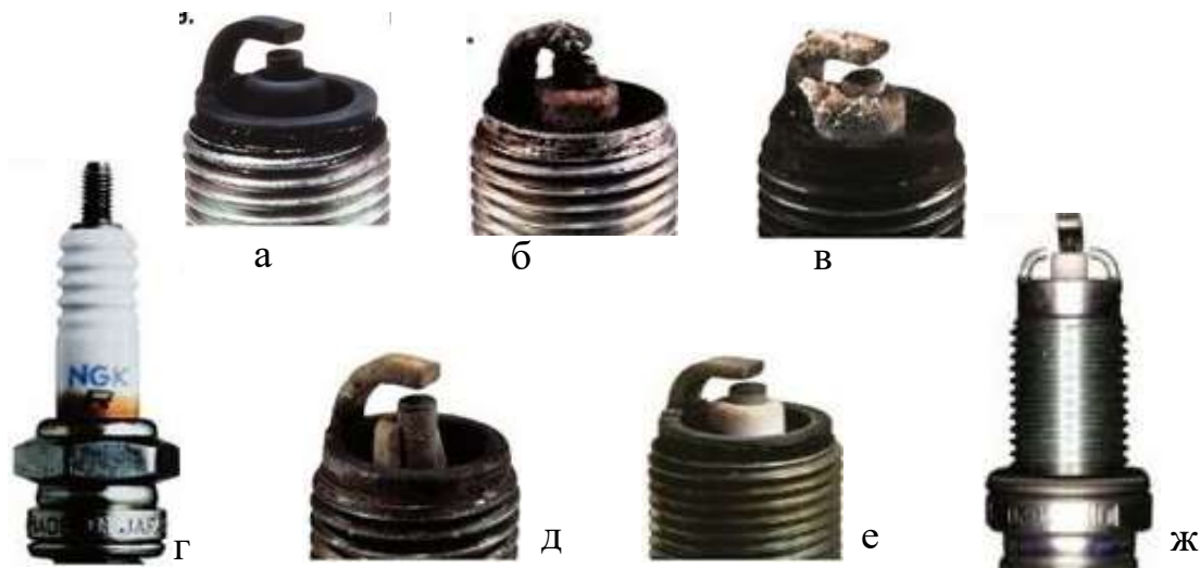
Рис. 3.1.1. Зовнішні ознаки несправних свічок запалювання:
