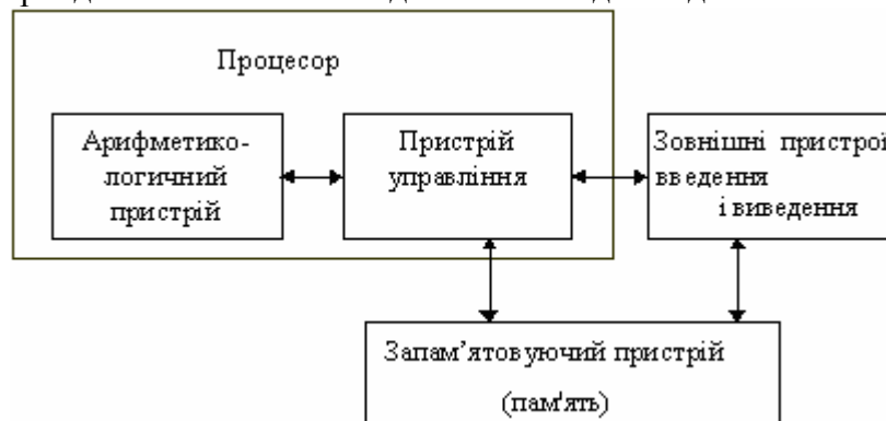
Рис. 4.1. Схема функціонування комп'ютера
