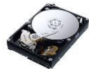
Рис. 5.5 Жорсткий магнітний диск
