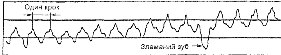
Рисунок 32 — Частина діаграми кінематичної похибки. Приклад інтерпретації
