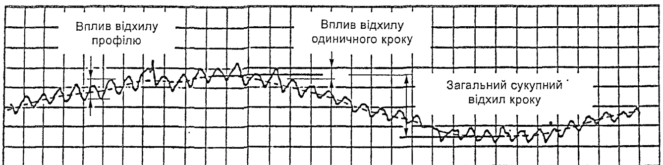
Рисунок 29 — Діаграми компонентів кінематичної похибки прямозубого циліндричного колеса
