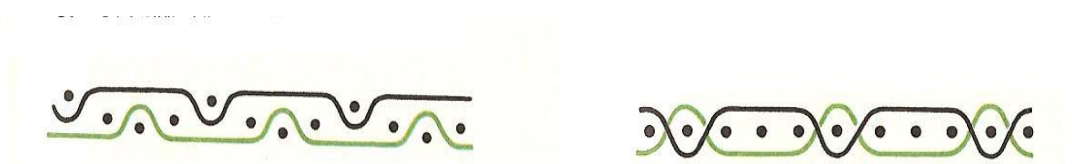
Рис. 3.11. Графічне зображення двошарових переплетень з різними способами зв'язку полотен
