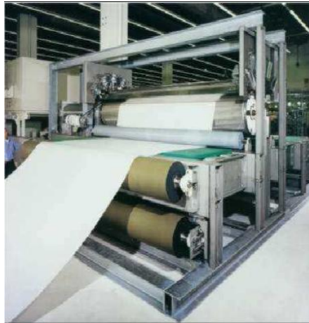
Рис.3.34. Виробництво клеєних нетканих полотен шляхом термоз'єднання
