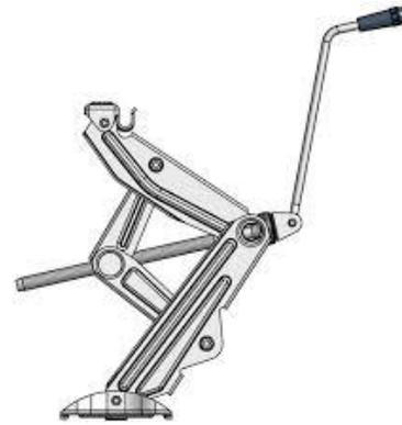
Рисунок 32.5 – Схема гвинтового домкрата
