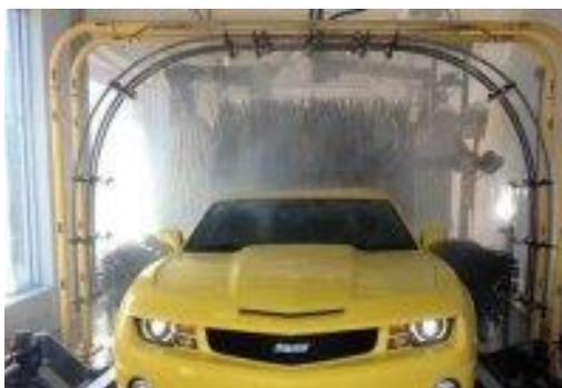
Рисунок 31.7 – Портальна автомобільна мийна установка SoftGloss MAXX
