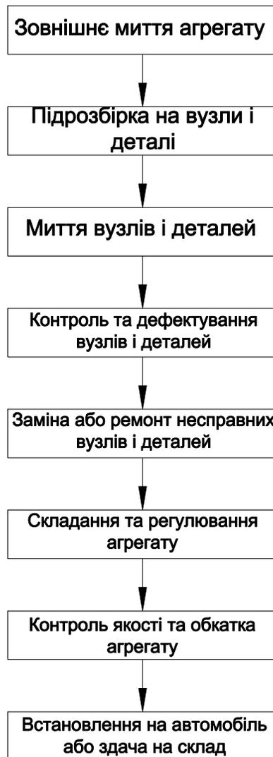
Рисунок 29.4 – Схема технологічного процесу ремонту у відділеннях
