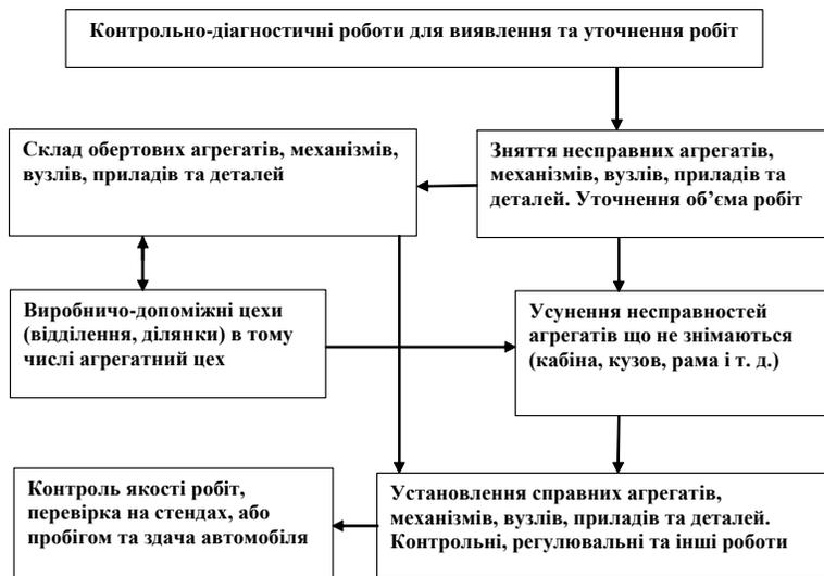
Рисунок 41.1 – Схема технологічного процесу ПР автомобіля
