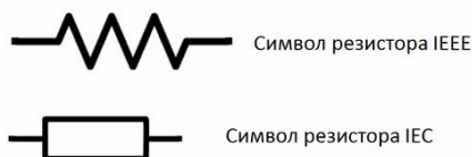
Рисунок 1.1 - Умовні графічні позначення резисторів на принципових електричних схемах
