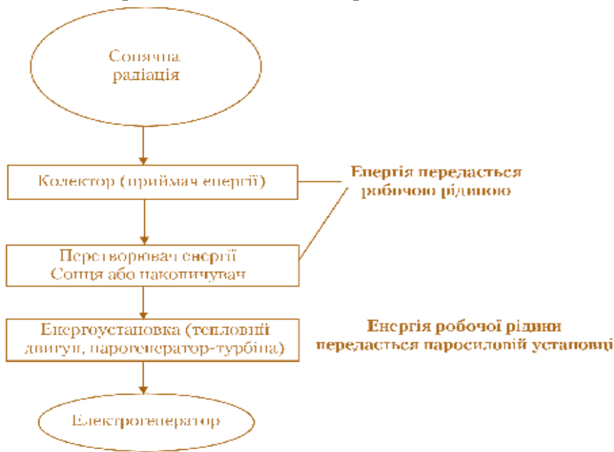
Рис. 5.1 - Принципова блок-схема сонячної теплоелектростанції
