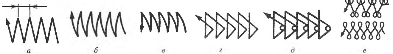
Рис. 42. Види коливальних (поперечних) рухів кінця електрода:
