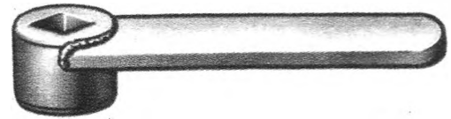
Рис. 64. Спеціальний ключ для кріплення редуктора і відкриття вентиля ацетиленового балона
