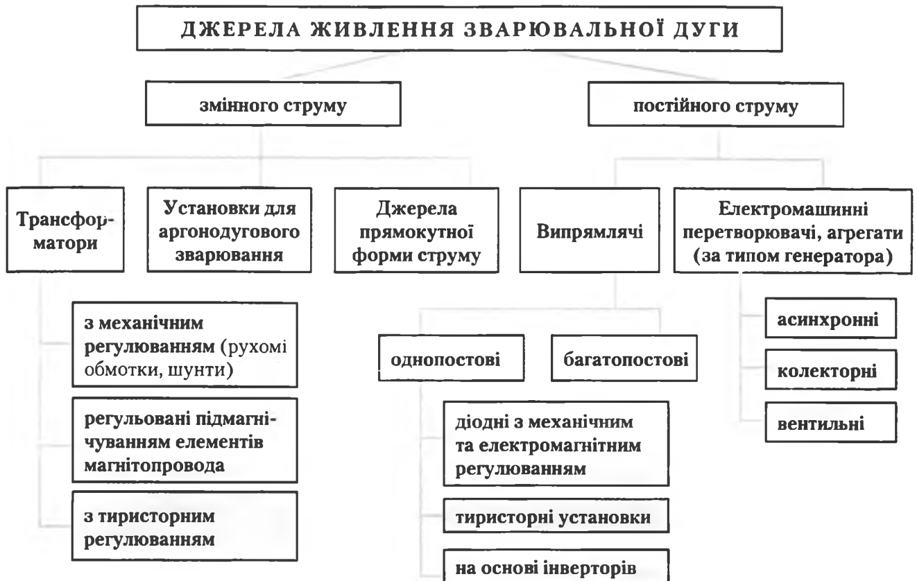
Рис. 15. Джерела живлення зварювальної дуги
