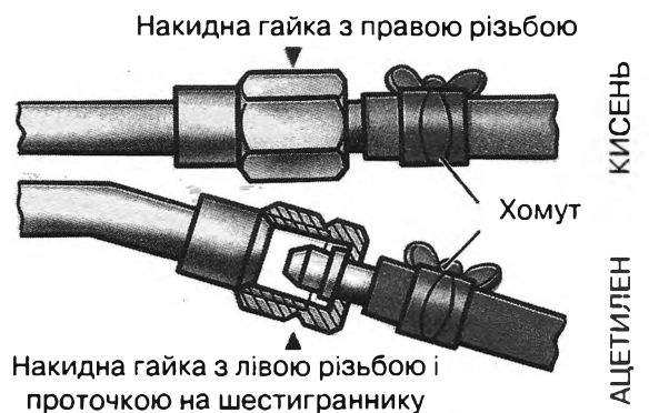
Рис. 74. Приєднання шлангів
