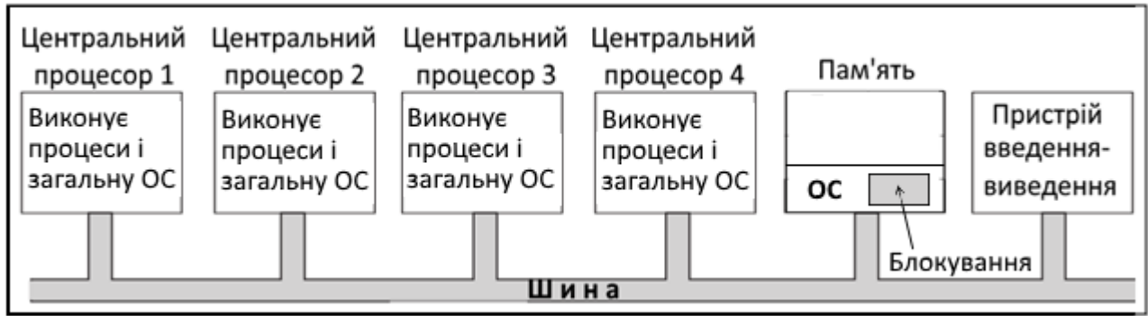
Рисунок 13.8 – Модель симетричного мультипроцесора
