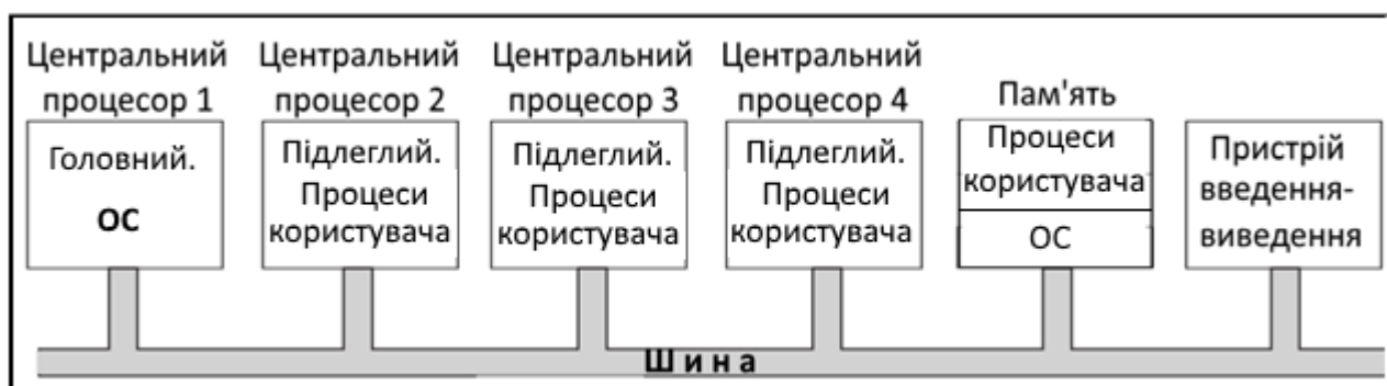
Рисунок 13.7 – Мультипроцесорна модель «головний-підлеглий»
