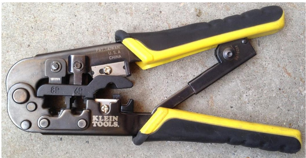
Рисунок 2.9 – Інструмент для обтискання витої пари (кримпер)
