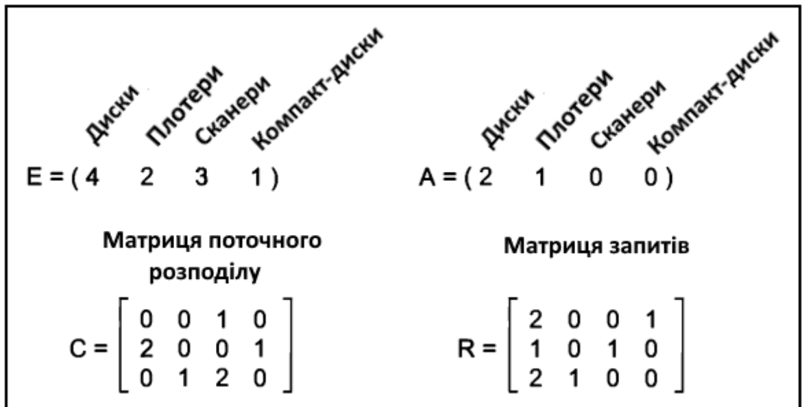
Рисунок 9.6 – Приклад, що демонструє роботу алгоритму виявлення взаємних блокувань
