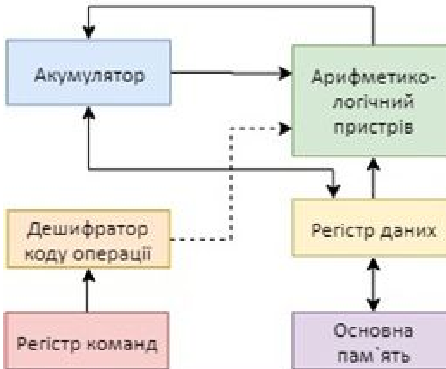
Рисунок 23.1 –Архітектура мікропроцесора на базі акумулятора
