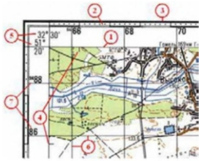
1 – внутрішня рамка карти; 2 – мінутна рамка; 3 – зовнішня рамка; 4 – виходи паралелей і меридіанів; 5 – значення широти і довготи кутів рамки; 6 – лінії кілометрової сітки; 7 – підписи кілометрової сітки Мал. 25. Рамка і кілометрова сітка топографічної карти (1 : 100 000)
