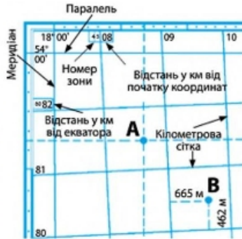
Географічні координати широта – \varphi = 54^{\circ}49'15'' ; довгота – \lambda = 54^{\circ}49'15'' Прямокутні координати X_B = 6\,080\,462 ; Y_B = 4\,309\,665 Мал. 26. Визначення географічних і прямокутних координат точок за картою
