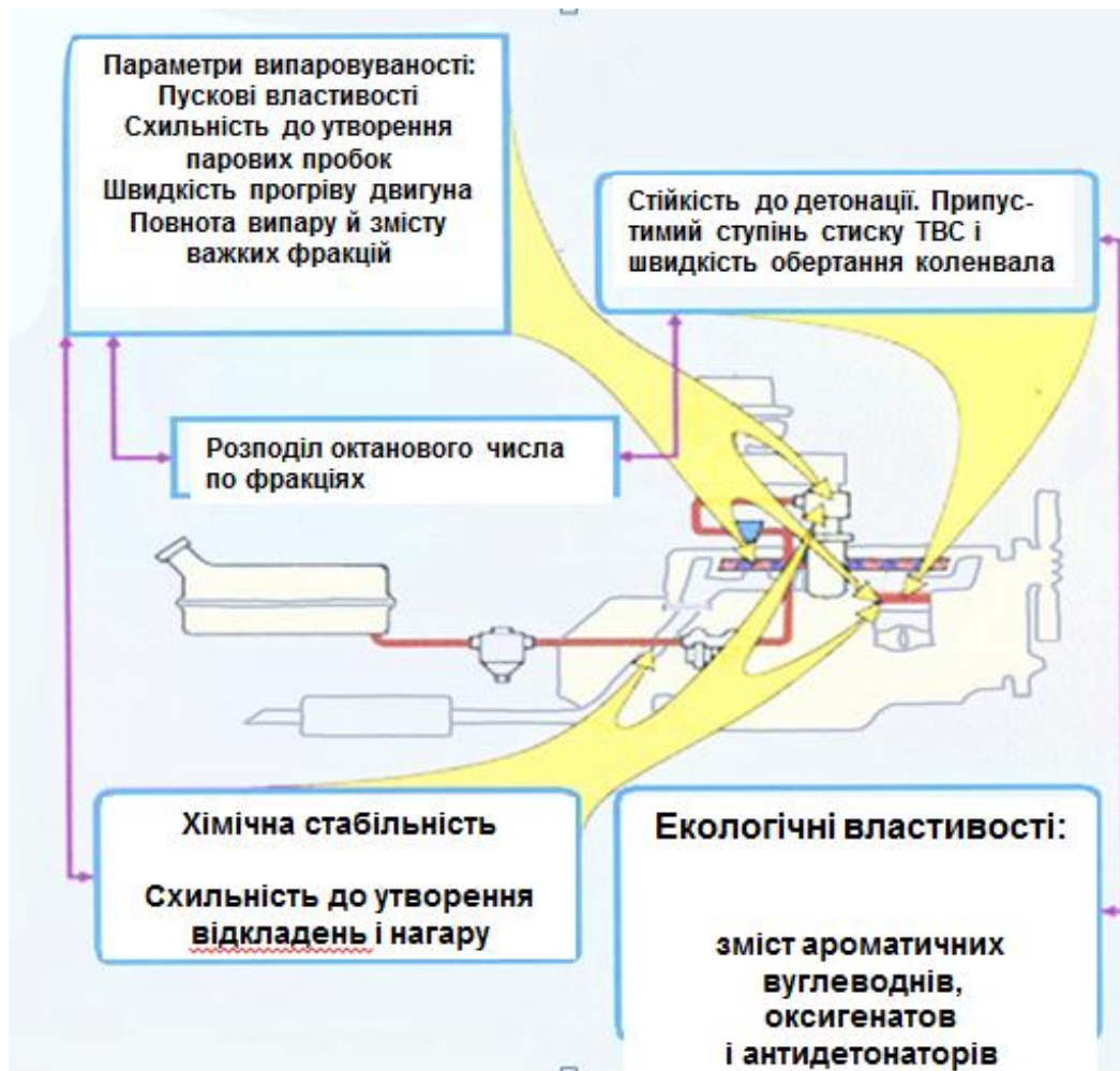
Рис. 7 Вплив показників бензина на якість роботи систем бензинового двигуна
