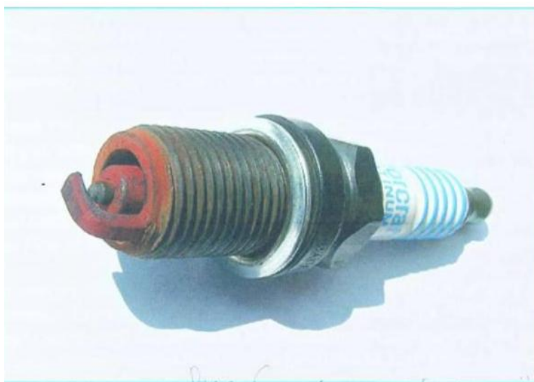
Рис. 4 Вплив наявності в бензині заліза, або інших металовмісних присадок.
