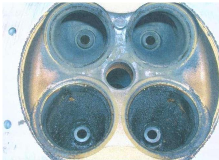
Рис. 5 Знос та нагароутворення гнізд клапанів.
