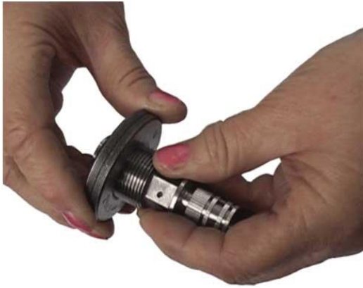
Рис.6.9.2.4. Контроль різьби непрохідними різьбовим кільцем
