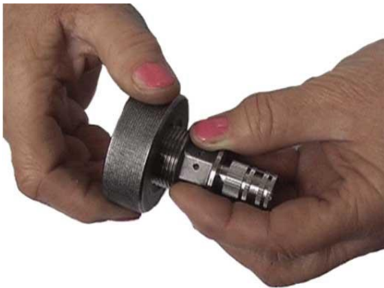
Рис.6.9.2.3. Контроль різьби прохідним різьбовим кільцем
